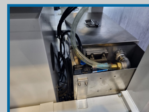
Système de refroidissement liquide de la broche
