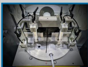
Dispositif de bridage pneumatique
