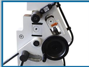
Volant de montée/baisse de rouleau arrière
